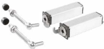
Charnières à ressort pour portillons de jardin. L'ensemble peut facilement être monté dans un profil carré de 40 mm. La force de fermeture du swing est facilement réglable à l'extérieur à l'aide d'une clé Allen.
