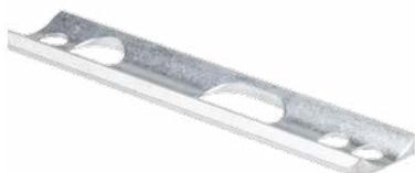
Plaque adaptateur de tube carré en tube rond pour la fixation des serrures. La plaque d'adaptation est montée entre la serrure et le poteau. Pour un montage parfait sur un poteau rond de  $\varnothing$  42 mm.
