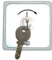
Schlüsselschalter sind in verschiedenen Ausführungen lieferbar: Rastend oder Tastend für Automatische Voll- / Teilöffnung, Verriegelung im geöffneten oder geschlossenen Zustand, Totmannfunktion (das Tor fährt solange der Taster betätigt ist). Weitere Funktionen auf Anfrage verfügbar.
